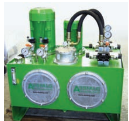
Produktbeispiel: kundenspezifisch aufgebautes Hydraulik-Aggregat – fertig für den Versand. Bilder: fluid
