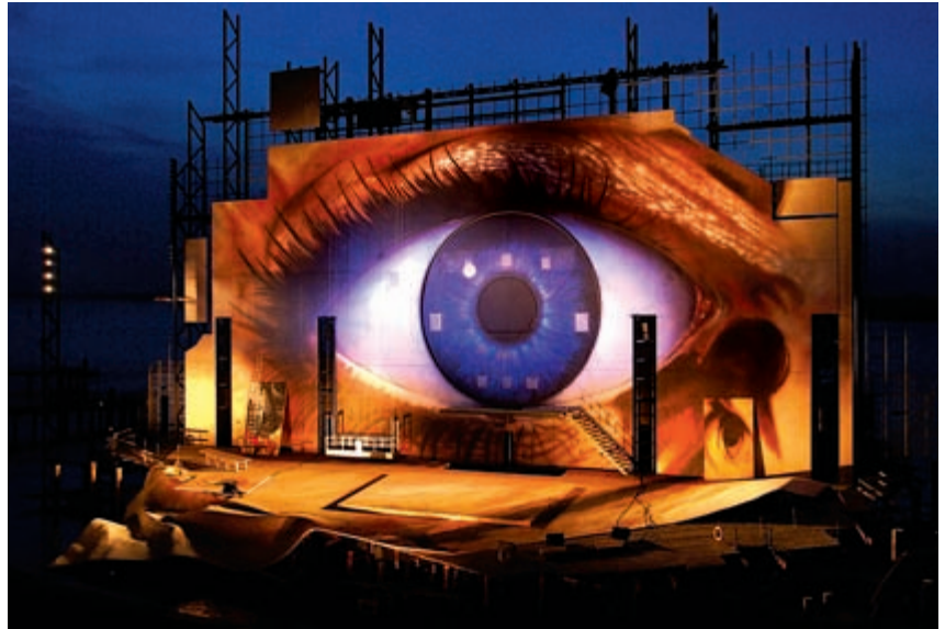
Bregenzer Seebühne: das hydraulisch nach vorn verfahrbare ‚Auge‘. Bilder: Assfalg
